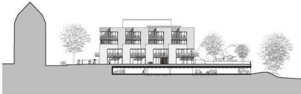
Ansicht Süd mit Schnitt durch das Untergeschoss (Tiefgarage)
